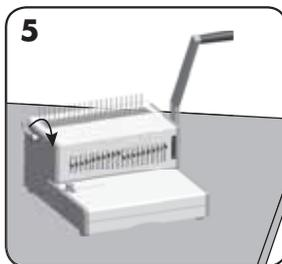
Aseta muovikampa paikoilleen avausmekanismiin. Avaa kampa vetämällä kamman avausvipua eteenpäin.
