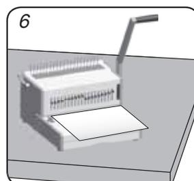
Διατρήστε δοκιμαστικά πρόχειρες σελίδες για να ελέγξετε τη ρύθμιση του οδηγού τοποθέτησης χαρτιού.
