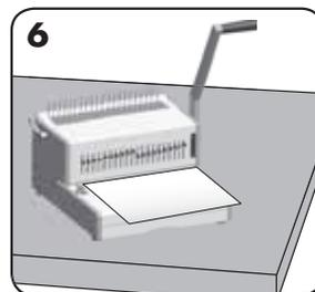
Faire un essai de perforation sur des feuilles de papier brouillon pour vérifier le réglage du guide latéral.
