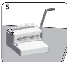
Włóż plastikowy grzebień do urządzenia. Podnieś dźwignię otwierającą grzebień.
