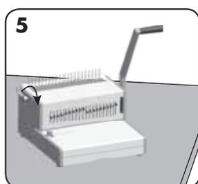
Indsæt plastikryggen i åbningsmekanismen. Træk ryghåndtaget fremad for at åbne ryggen.
