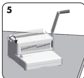
Inserira a argola de plástico no mecanismo de abertura. Puxe a alavanca de abertura de argolas para a frente de modo a abrir a argola.
