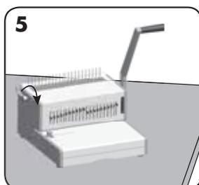
Plastično špiralo vstavite v mehanizem. Da boste odprli špiralo, potegnite vzvod za odpiranje špirale.
