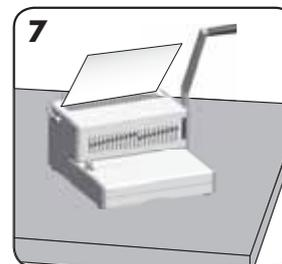
Coloque las hojas perforadas directamente en el canutillo abierto.
