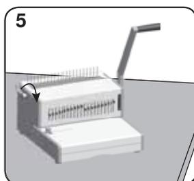
Вставьте пластиковую гребенку в открывающий механизм. Потяните рычаг для открывания вперед, чтобы открыть гребенку.
