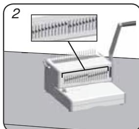
Επιλέξτε το σωστό προφίλ διάτρησης ανάλογα με το μέγεθος του φύλλου. Επιλέξτε τις κατάλληλες αποσυμπλεκόμενες κεφαλές διάτρησης.
