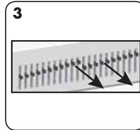
Pour annuler une perforation, tirer sur la goupille. Réaliser un essai de perforation sur une feuille.
