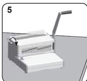
Introduceți pieptenele de plastic în mecanismul de deschidere. Trageți maneta de deschidere a pieptenului pentru a deschide pieptenul.
