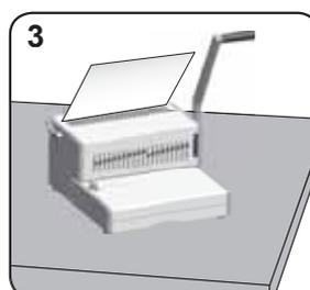
Încărcați foile perforate direct în pieptenele deschise. Începând cu partea frontală a documentului.
