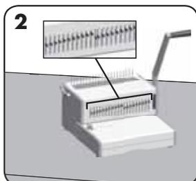
Velg korrekt hulleprofil for arkstørrelsen. Velg ønskede utløsbare stempler.
