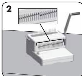
Selezionare il profilo di perforazione adeguato alle dimensioni del foglio. Selezionare i punzoni rimovibili secondo necessità.
