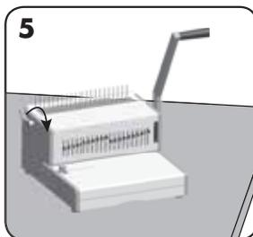
Insérer le peigne plastique dans le mécanisme d'ouverture. Tirer sur le levier d'ouverture du peigne pour l'ouvrir.
