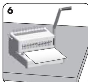
Lag hull i prøveark for å kontrollere at kantinnstillingen er korrekt.
