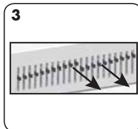
Dra en viss nål framåt för att utesluta den från håslagningen. Testa att stansa ett papper.
