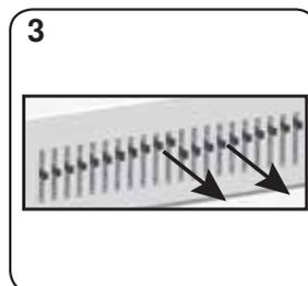
Ak chcete zrušiť perforáciu, potiahnite kolík dopredu. Vykonajte skúšobnú perforáciu hárka.
