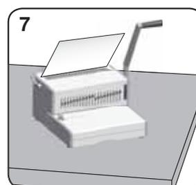
Nasadte děrované listy přímo na otevřený hřeben.
