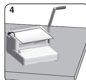
Po załadowaniu wszystkich kartek do grzebienia pociągnij dźwignię grzebienia do tyłu, aby zamknąć grzebień i wyjmij oprawiony dokument.
