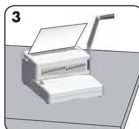
Legg hullede ark direkte på den åpne kammen. Start med dokumentets forside.
