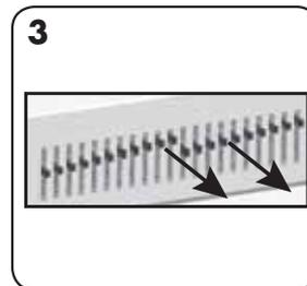
Za poništenje probijanja, povucite zatik prema naprijed. Izvršite probno probijanje.
