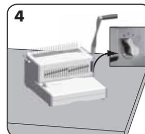
Vælg den korrekte dybde for bagmargenen i forhold til antallet af ark.
