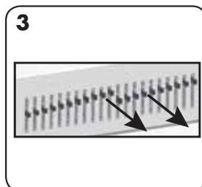
For å hoppe over et hull, trekk stiftene fremover. Lag hull i et prøveark.
