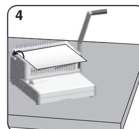
После загрузки всех пробитых листов на гребенку отведите рычаг назад для закрывания гребенки и вытащите переплетенный документ.
