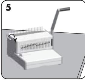
Açma mekanizmasına plastik tarağı yerleştirin. Tarağı açmak için tarak açma kolunu ileri doğru çekin.
