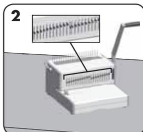
Vælg den korrekte udstansningsprofil til arkstørrelsen. Vælg udløselige matricer efter behov.
