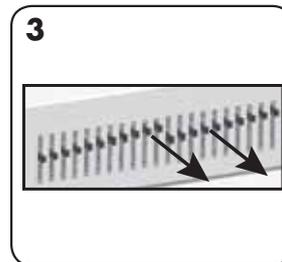
Para anular un taladro, tire de la clavija hacia delante. Realice una perforación de prueba en una hoja.
