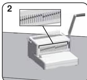
Vyberte správný profil děrování pro danou velikost listu. Vyberte vhodné nastavení uvolnitelných nožů.
