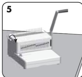
Introduzca el canutillo de plástico en el mecanismo de apertura. Tire de la palanca de apertura de canutillos hacia delante para abrirlo.
