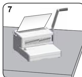
Încărcați foile perforate direct în pieptenele deschise.
