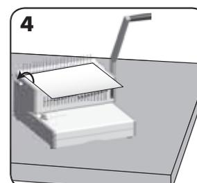
Wenn alle gestanzten Blätter auf dem Binderücken liegen, schieben Sie den Hebel nach hinten, um den Binderücken zu schließen, und entnehmen Sie das fertig gebundene Dokument.
