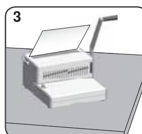
Vložte perforované hárky priamo do otvoreného hrebeňa. Začnite od začiatku dokumentu.
