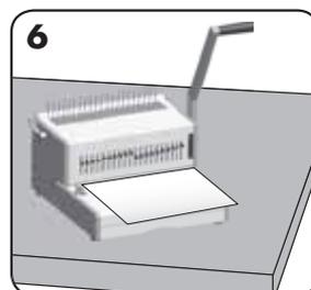
Faça furos de teste em folhas que tencione deitar fora para verificar a colocação da guia de margem.
