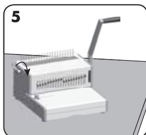
Plaats de kunststof bindrug in het openingsmechanisme. Trek de bindrughendel naar voren om de bindrug te openen.
