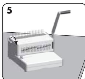
Legen Sie den Plastikbinderücken in den Öffnungsmechanismus ein. Ziehen Sie den Hebel nach vorne, um den Binderücken zu öffnen.
