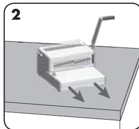
2 Tarkista, että silppusäiliö on tyhjä ja paikoillaan.
