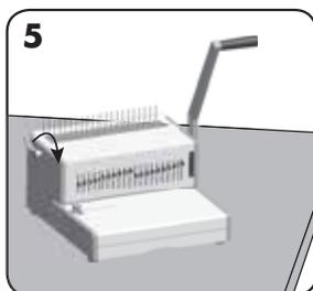
Placera plastkammen i öppningsmekanismen. Dra spaken för kamöppning framåt för att öppna kammen.
