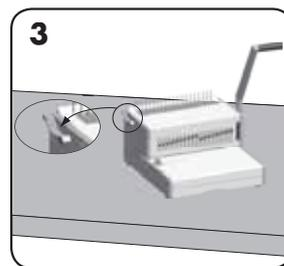
Påse at kamåpningsspaken er skjøvet bakover.
