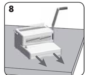
Tyhjennä silppusäiliö säännöllisesti, mieluiten joka käyttökerran jälkeen.
