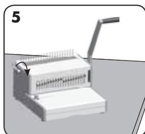
Før plastkammen inn i åpningsmekanismen. Trekk kamspaken frem for å åpne kammen.
