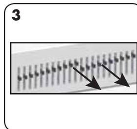
Um einen Lochstempel auszuklinken, ziehen Sie den Stift nach vorn. Führen Sie eine Probetanzung durch.
